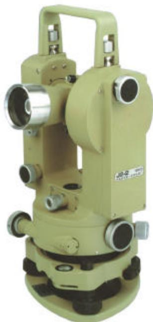
VLJ2-2 è un teodolite meccanico autolivellante dotato di compensatore automatico per la massima precisione ed affidabilità di misurazione.
